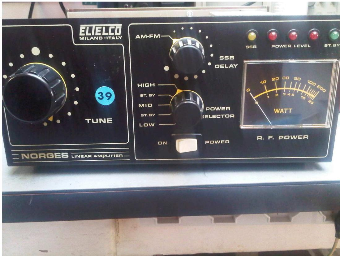
Questo lineare monta una valvola EL519 con ingresso e uscita LC parallelo dato per 200W in banda CB.
